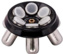
Rotore ad angolo fisso 37° per provette da 100 ml | 5000                  | 3330            | 6                  | 40100822 |
